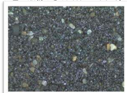
石狩望来海岸の“砂鉄”: 磁石にくっつくのが特徴で、磁鉄鉱という鉄の原料になる鉱物。火山岩などに含まれる
